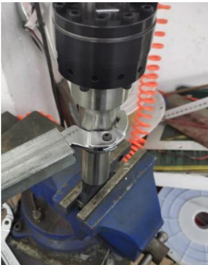
Прижмите угол к боковой стороне сварочной головки и закрепите винты тройки сварочной головки, чтобы обеспечить вертикальное положение сварочной головки.
