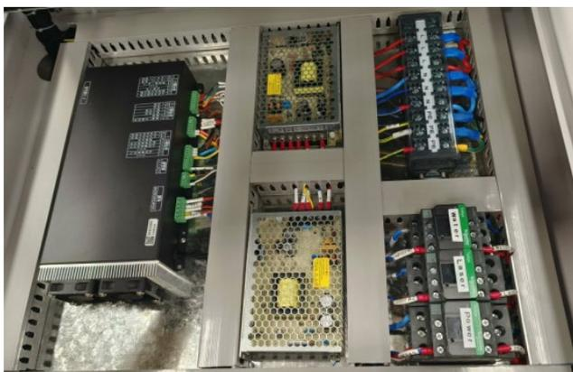
1. Распределительный щит, почти все электрические компоненты установлены в распределительном щите. И обеспечивают питание станка.
