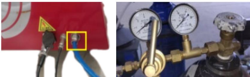
1. В качестве вспомогательного газа в лазерных сварочных аппаратах используется азот или аргон. Давление воздуха в устройстве доступа должно составлять около 0,4 МПа. Чистота газа должна быть не менее 99,99%
