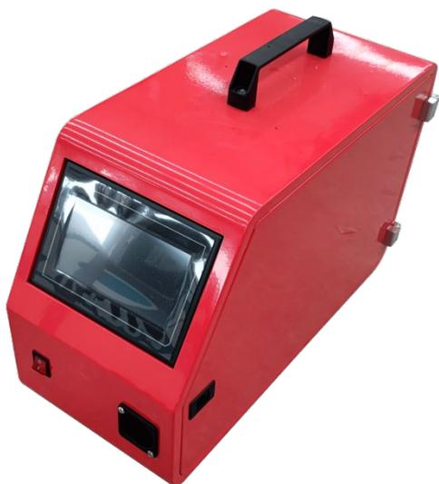
Система подачи проволоки представляет собой интерфейс с цифровым дисплеем, на котором можно задать скорость подачи проволоки, ручную подачу и ручной отвод проволоки и другие функции.
