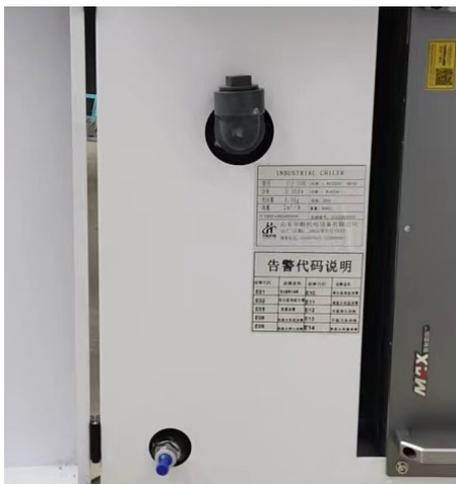
В системе водяного контура лазерного сварочного аппарата используется двухтемпературный чиллер, который охлаждает лазер по ходу движения и охлаждает режущую головку по ходу движения.
