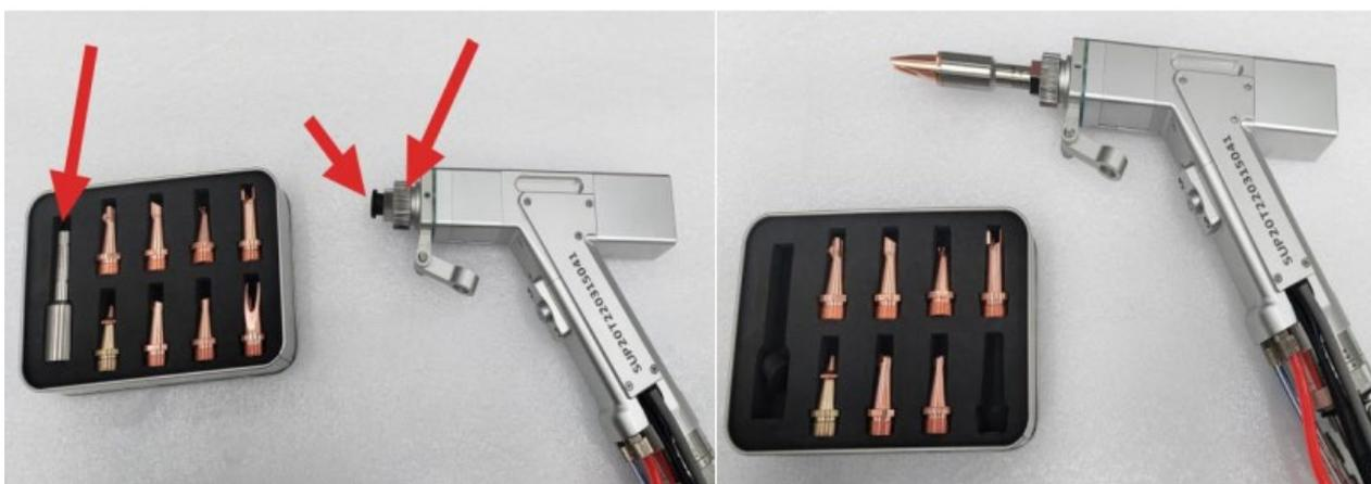
Снимите пылезащитную пробку сварочной головки, ослабьте крепежные винты и установите трубку со шкалой и медное сопло. Тип медной насадки выбирается в зависимости от требований.
