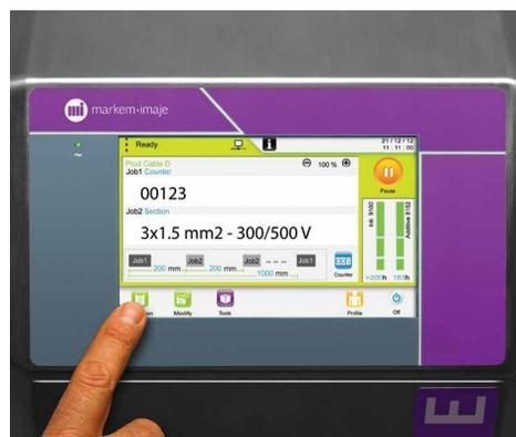
Специальный пользовательский интерфейс (UI) для экструзии: измерение, чередование 2 сообщений, быстрый доступ к настройкам счетчика, оптимизация контроля допуска и т.д.
